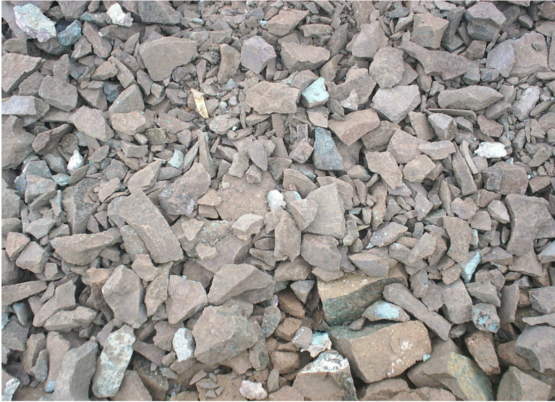
Figura 7. Detalhe do rejeito extraído no processo de exploração de pedras ametista.
