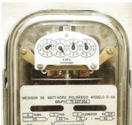
Nos contadores do consumo de energia elétrica das residências, conforme a corrente passa, faz girar um disco horizontal que dá movimento aos ponteiros dos "reloginhos".
