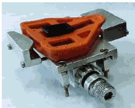
**Figura 4:** plataforma de força biaxial.
