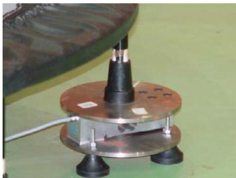
**Figura 3:** plataforma de força uniaxial ( $F_z$ ).
