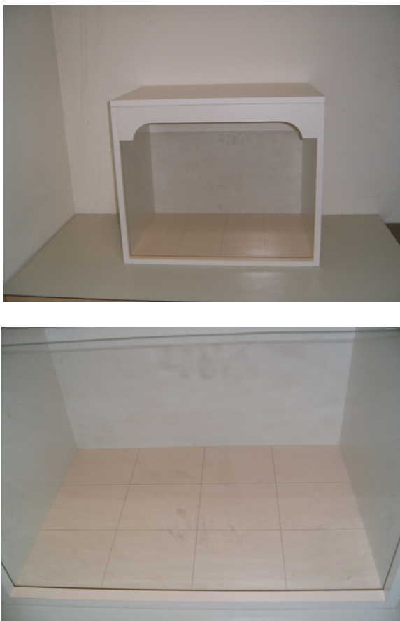
Figura 7. Caixa de madeira para observação em campo aberto, recoberta por fórmica (interna e externamente), medindo 50 x 60 x 40 cm de profundidade, com face anterior de vidro e assoalho dividido em 12 retângulos de 15,0 x 13,3 cm, com linhas escuras.
