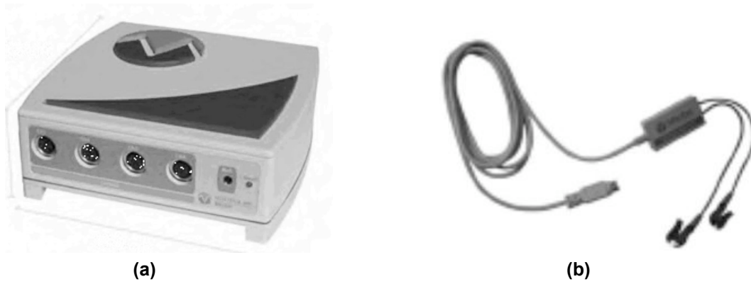
Figura 15: (a) Eletromiógrafo Miotool 400 e (b) sensor SDS 500 com distância regulável entre os eletrodos.
