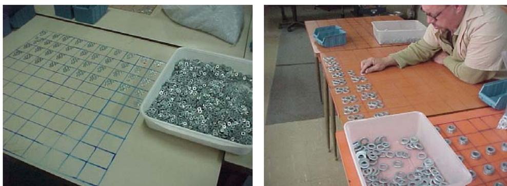
**Figura 30 - Moldes nos tampos para facilitar a contagem**
