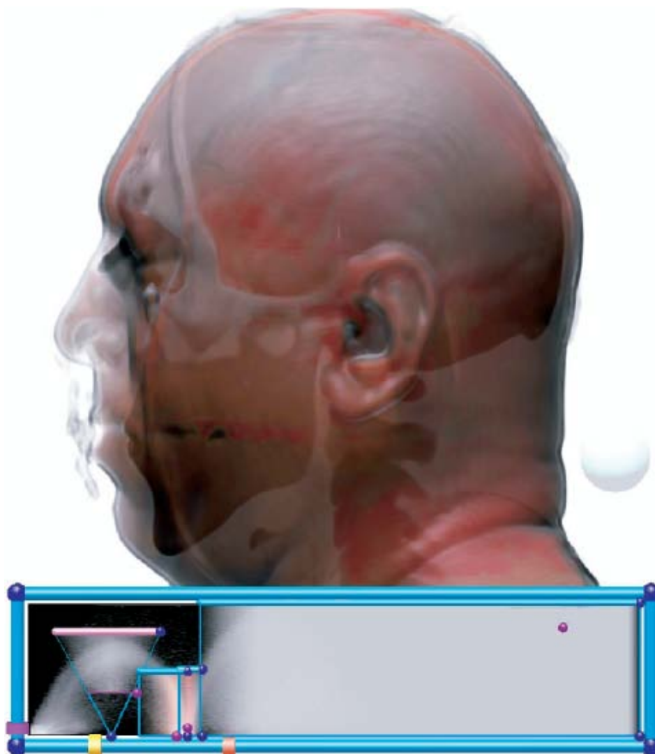
Figura 3.3: Interface da ferramenta desenvolvida por Kniss para definição de funções de transferência tridimensionais. Na parte inferior é apresentado, em tons de cinza, o histograma dos voxels, inseridos de acordo com seu valor escalar e magnitude do gradiente, onde um arco pode claramente ser visto. Widgets geométricos são utilizados como meio de definir a FT. Reprodução da figura contida em [KNI 2002b].
