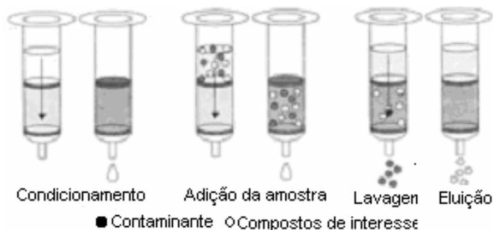
Figura 3.5: Princípio da técnica SPE. Fonte: Lanças (2004).
