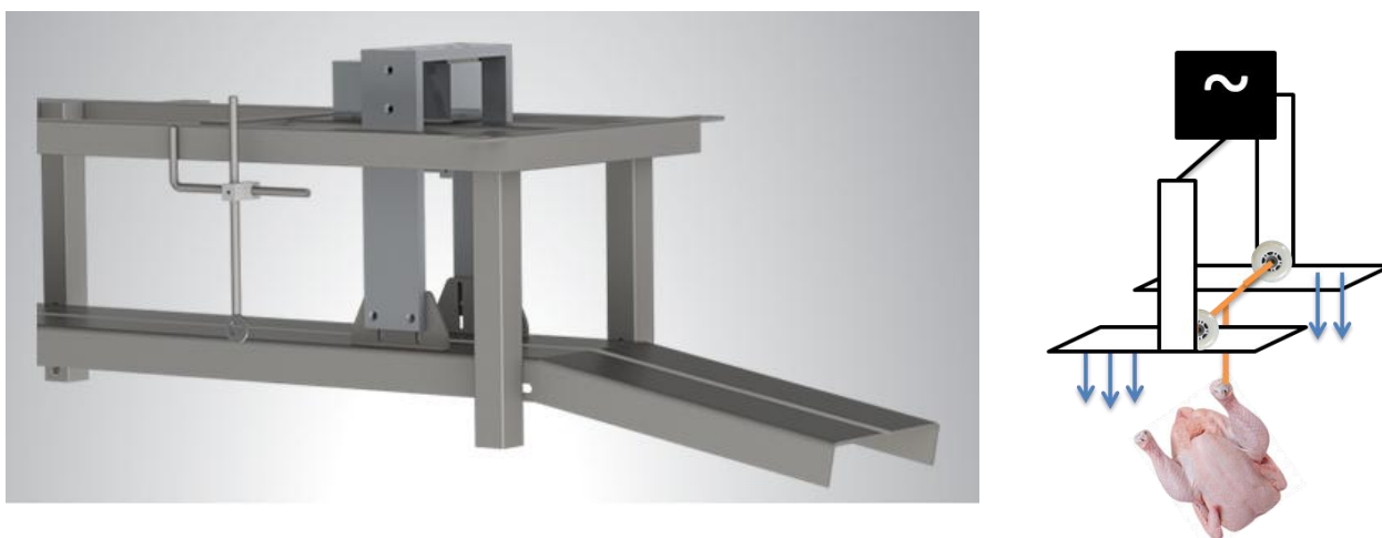
Figura 5 - Estação de pesagem e conjunto frango + gancho
