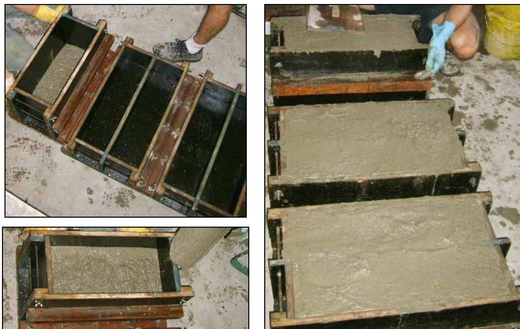
Figura 6.3 – Lançamento da mistura nas fôrmas de madeira.
