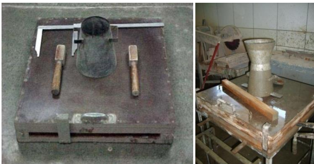
Figura 4.7 – Mesa de Graff para verificação do espalhamento da mistura.
