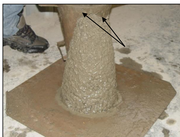
d) Ponto C'' – Teor de fibra: 1,15% (1/8 Polip + 3/8 Carb + 1/2 Aço)
