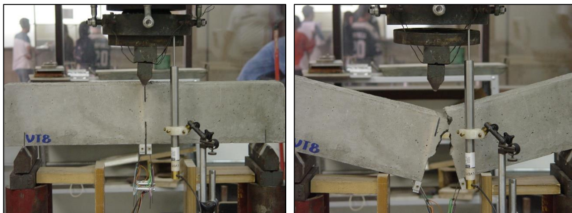
Figura 5.6: Ruptura brusca da matriz – comportamento frágil do concreto
