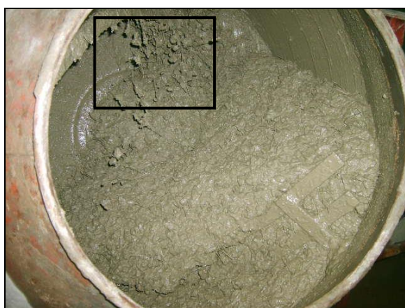
a) Ponto B'' – Teor de fibra: 1,15% (3/8 Polip + 1/8 Carb + 1/2 Aço)
