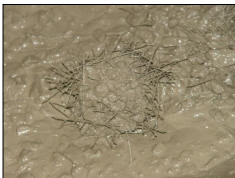
a) Ponto B'' – Teor de fibra: 1,15% (3/8 Polip + 1/8 Carb + 1/2 Aço)
