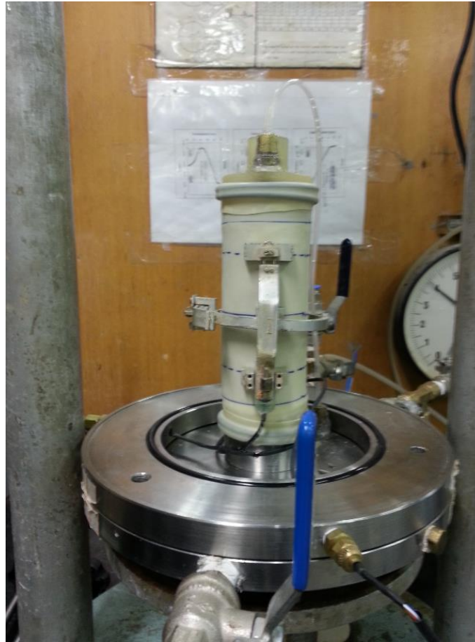
Figura 3-13: Posicionamento dos sensores de efeito hall, axial e radial
