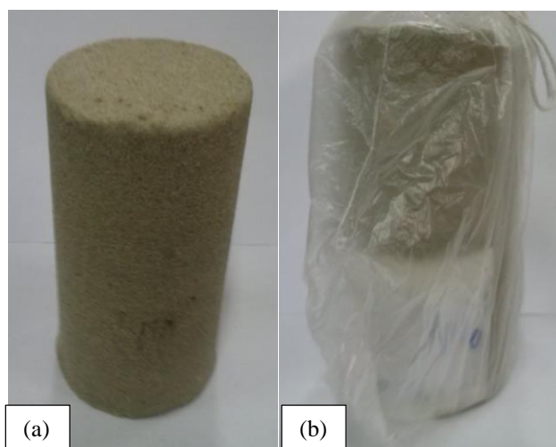
Figura 3-7: Corpo de prova areia-cimento, (a) aspecto final e (b) identificado e vedado
