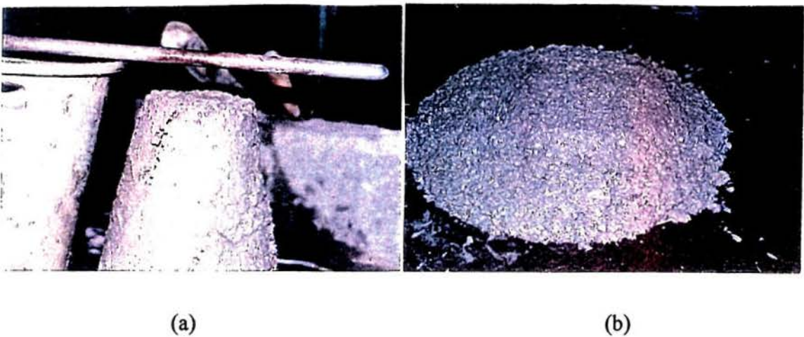
FIGURA 6.29 - Trabalhabilidade do traço 1:5 com 70% de EVA e aditivo incorporador de ar
