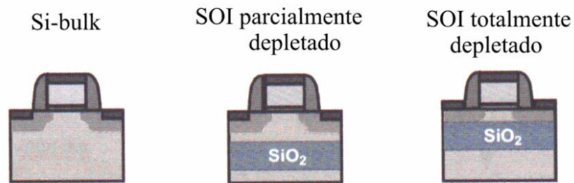
Figura 2.12: Ilustrações de dispositivos MOS construídos em diferentes estruturas.
