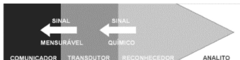
Figura 1: Esquema geral dos principais componentes de um sensor eletroquímico.<sup>6</sup>
