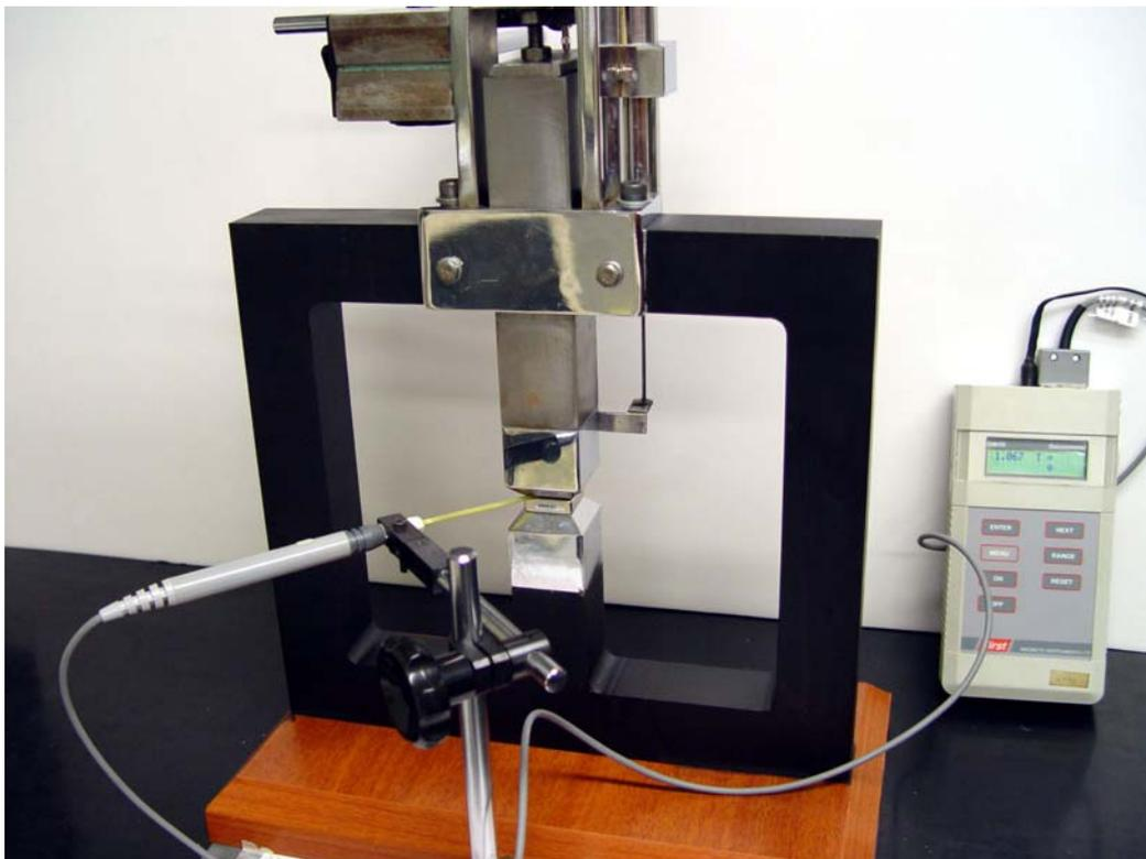
Figura 69. Configuração de medição da densidade de fluxo no entreferro.
