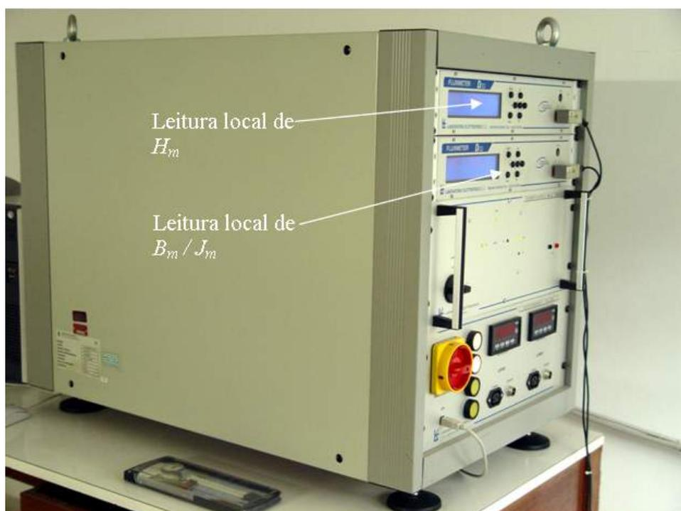
Figura 94. Equipamento de aquisição de dados e controle do histerisímetro do IPT.
