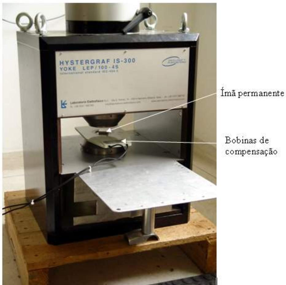
Figura 93. Culatra do histerisímetro usado para testar os ímãs permanentes.
