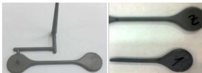
Figura 63 - Corpo de prova de tração injetado.
