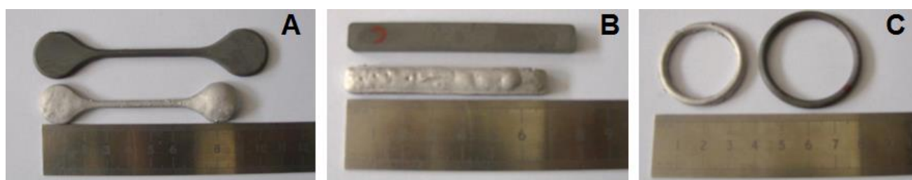
Figura 77 - Peças sinterizadas comparadas as peças a verde; A - corpo de tração; B-Corpo de flexão e C - Anel de Rowland.
