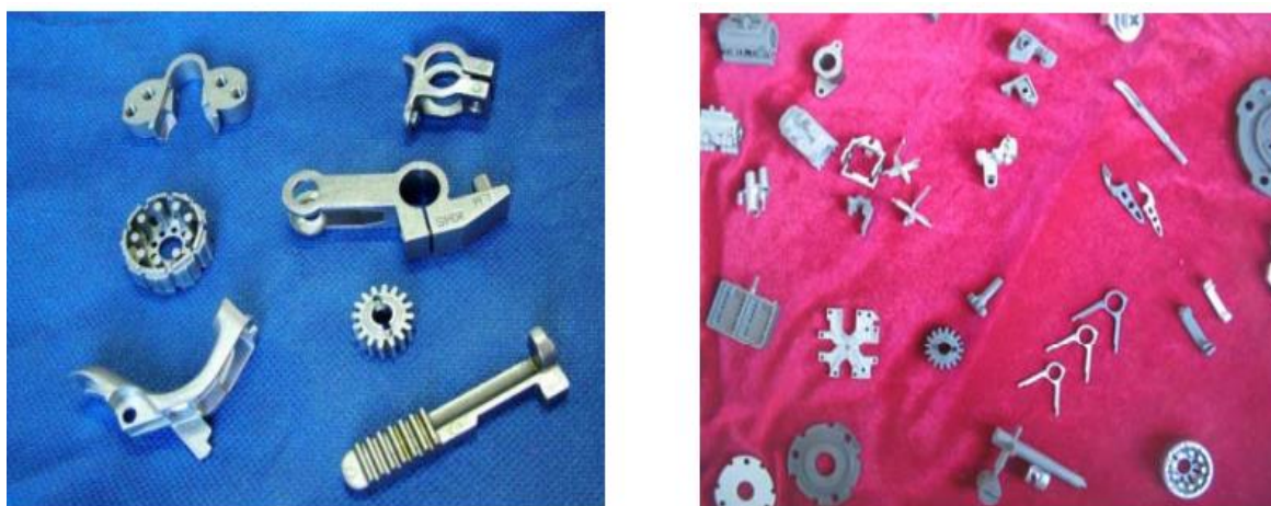
Figura 7- Peças sinterizadas obtidas pelo processo de MPI.
