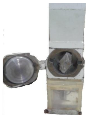
Figura 40 - Granulador modelo Seibt, modelo MGHS 1.5/85.
