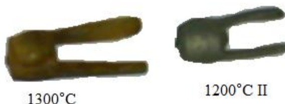
Figura 86 - Respostas dos componentes após quatro semanas a corrosão generalizada.
