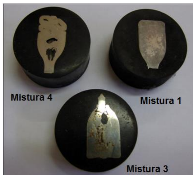
Figura 61 - Amostras embutidas depois sinterizadas
