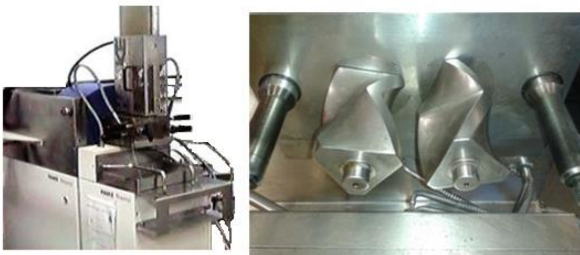
Figura 39 - Reômetro de torque do SENAI CETEPO
