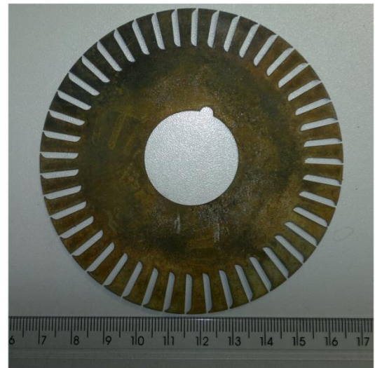
Figura 61 Confeção das lâminas do pacote do rotor: (a) lâminas cortadas em processo de secagem e (b) detalhes da lâmina cortada.
