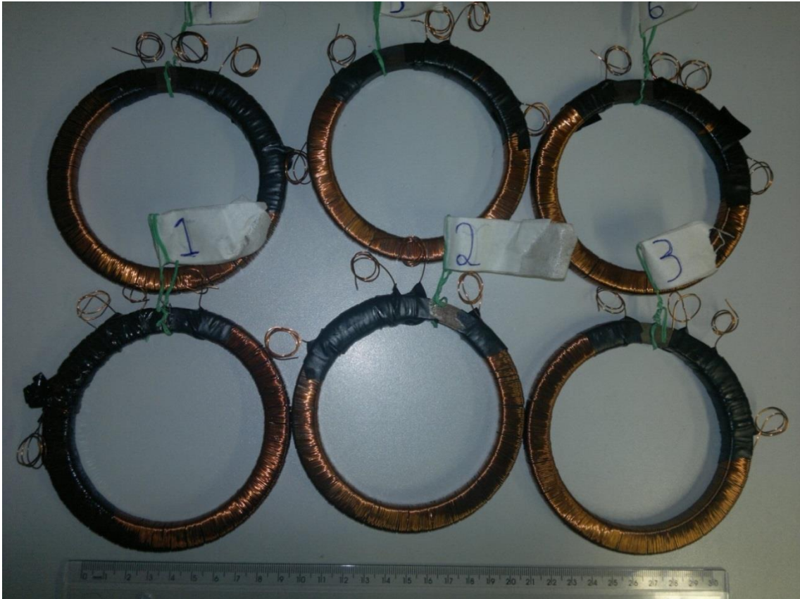
Figura 1 – Amostras (núcleos toroidais) com enrolamentos do primário e secundário inseridos.
