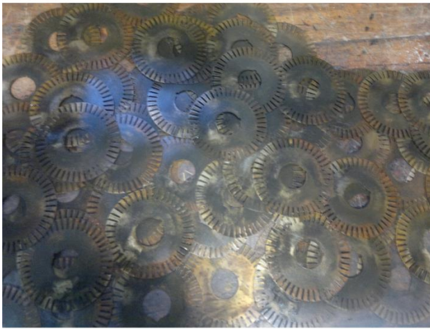
Figura 61 Confeção das lâminas do pacote do rotor: (a) lâminas cortadas em processo de secagem e (b) detalhes da lâmina cortada.
