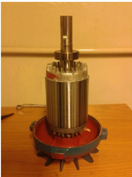
Figura 62 Protótipo do rotor do gerador de indução: (a) rotor com tampa e ventilador e (b) vista a partir da ponta do eixo.
