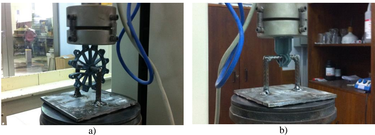
Figura 32 - Ensaio de capacidade de carga: a) em espaçadores circulares; b) em espaçadores cadeirinha.
