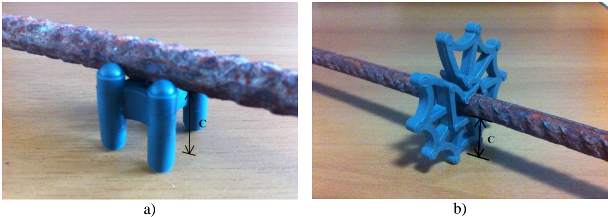
Figura 28 - Método de avaliação do desempenho físico: a) em espaçadores tipo cadeirinha; b) em espaçadores circulares.
