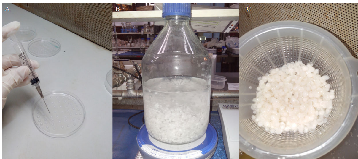
Figura 1. Processo de imobilização celular em Lentikats®: gotejamento em placa de petri (a), estabilização e reentumecimento em solução estabilizadora (b), “lentilhas” prontas (c).
