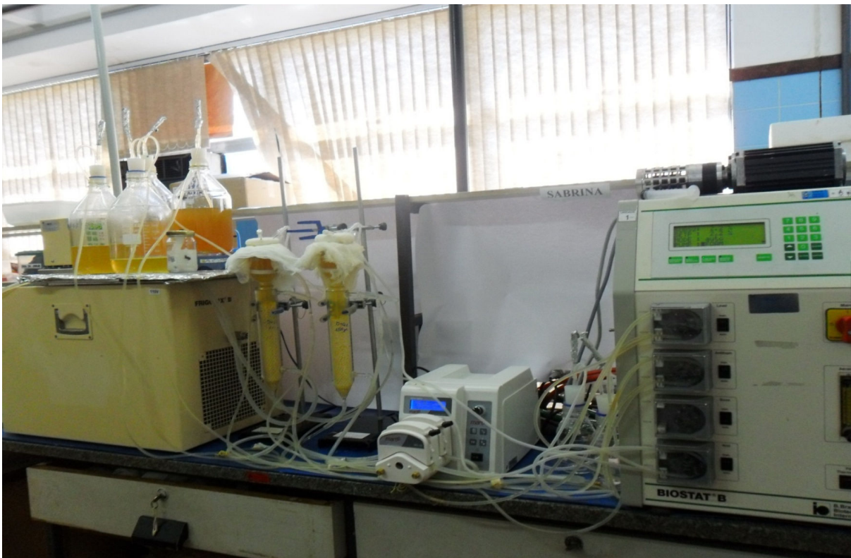
Figura 2.5 Biorreator de coluna leito fluidizado com células imobilizadas operado continuamente (Fonte: o autor).
