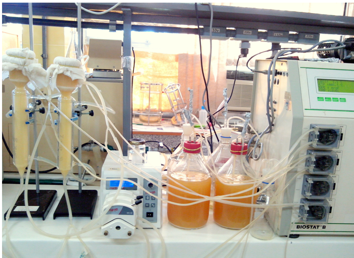
Figura 2.6. Sistema contínuo de produção de etanol utilizando a técnica A-stat com células livres (Fonte: o autor).
