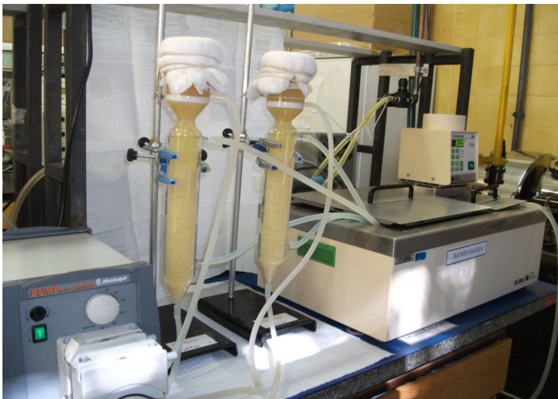
Figura 2.4. Biorreator de leito fluidizado com células imobilizadas operado em regime batelada (Fonte: o autor).
