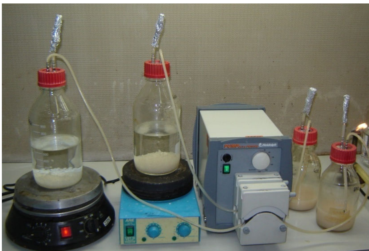
Figura 2.1 Processo de imobilização celular em esferas de alginato de cálcio (Fonte: o autor).
