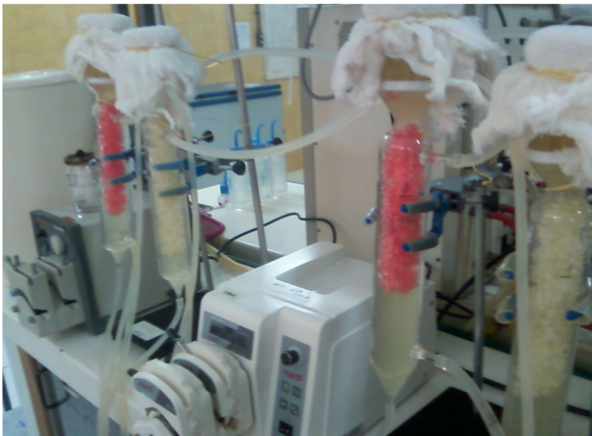
Figura 2. Produção de etanol em biorreatores de leito fixo utilizando como material suporte esponjas de poliuretano (PUF), e poliéster (PE).
