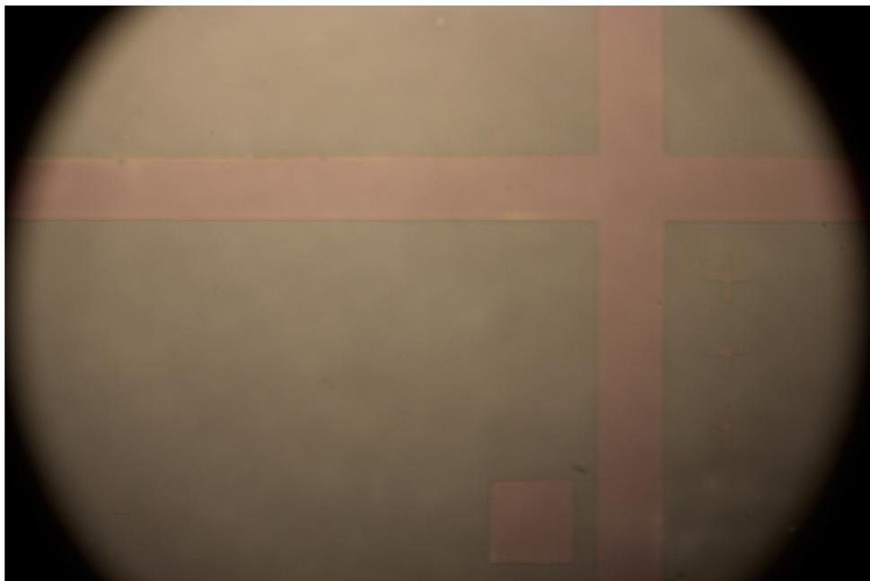
Figura 4.19: Amostra de ITO sem implantação após a realização de Litografia.
