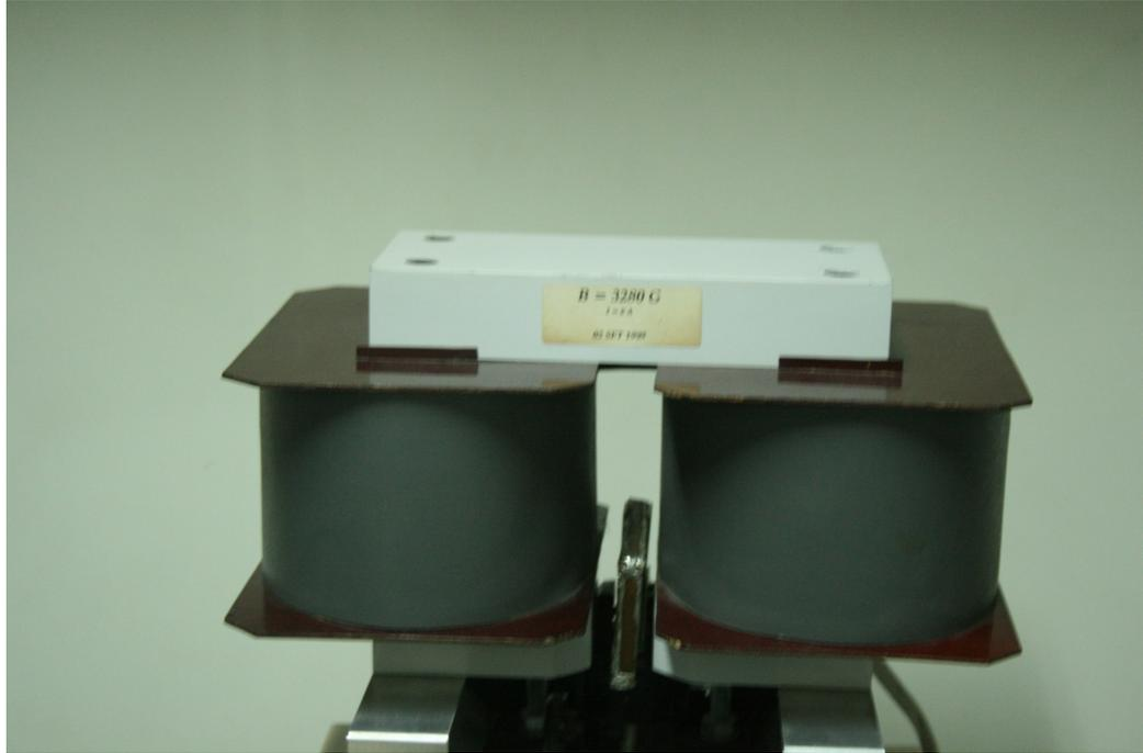
Figura 3.14: Ímãs geradores do campo magnético. O porta amostras é colocado no receptáculo localizado entre os ímãs.
