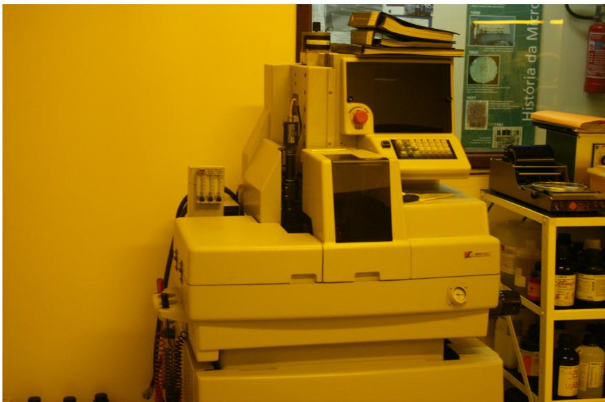
Figura 3.1: Máquina de Corte utilizada para cortar as placas de ITO para confeccionar as amostras.
