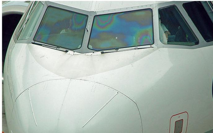
Figura 1.1: [1]Janela de aeronave Airbus com filme fino de ITO depositado sobre a superfície.
