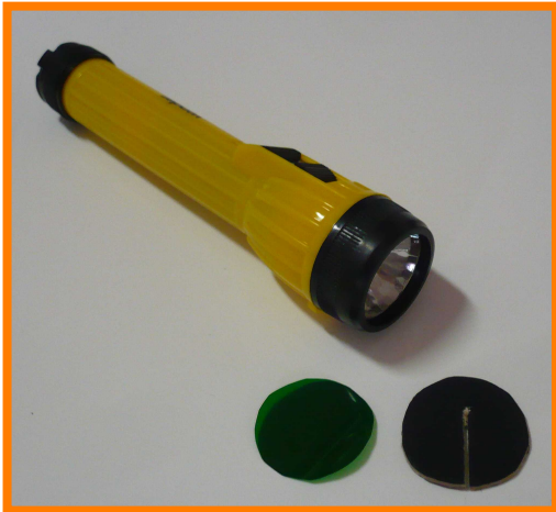
Figura 5.4: Papel cartão com uma fina fenda e filtro plástico colorido para serem encaixados na lente da lanterna.
