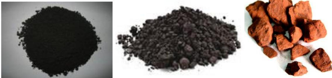
Figura 3 – Principais produtos de minério de ferro em Carajás - Pellet Feed, Sinter Feed e Lump Ore
