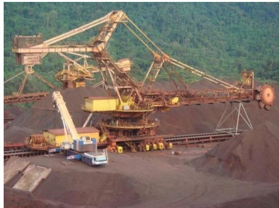
Figura 5 – Diagrama esquemático e foto de Recuperadora
