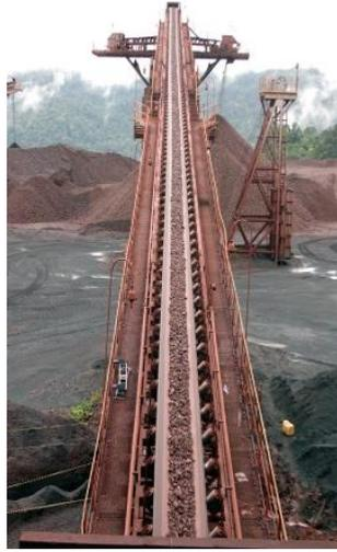
Figura 4 – Diagrama esquemático e foto de Correia Transportadora
