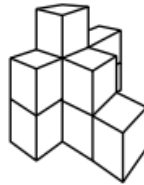
Figura 7 - Exemplo de projeção em perspectiva Fonte: Gutiérrez, 1998, p. 196
