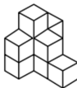
Figura 9 - Exemplo de projeção isométrica Fonte: Gutiérrez, 1998, p. 196
