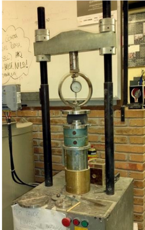
Figura 4.6: ensaio de tração por compressão diametral
