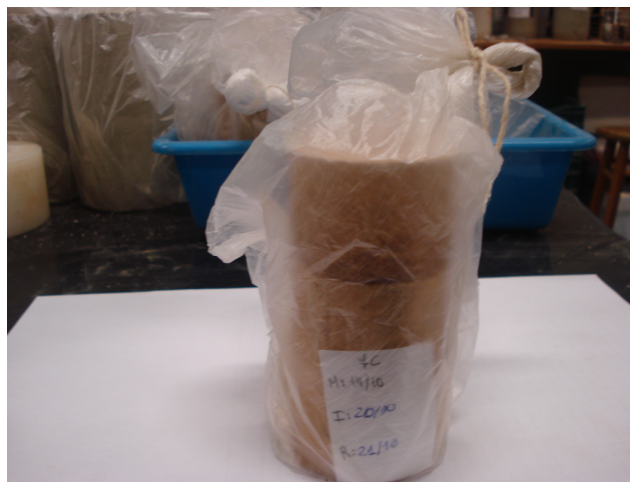
Figura 4.5: corpo-de-prova acondicionado em saco plástico e identificado
