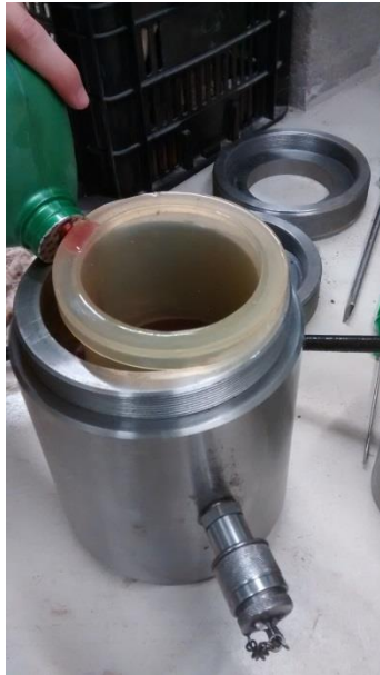
Figura 22: despejo do óleo entre a luva e a célula
