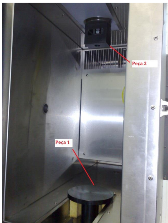
Figura B.5: Posicionamento de peças na câmara de temperatura
