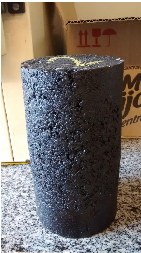
Figura 37: abaulamento lateral do CP
