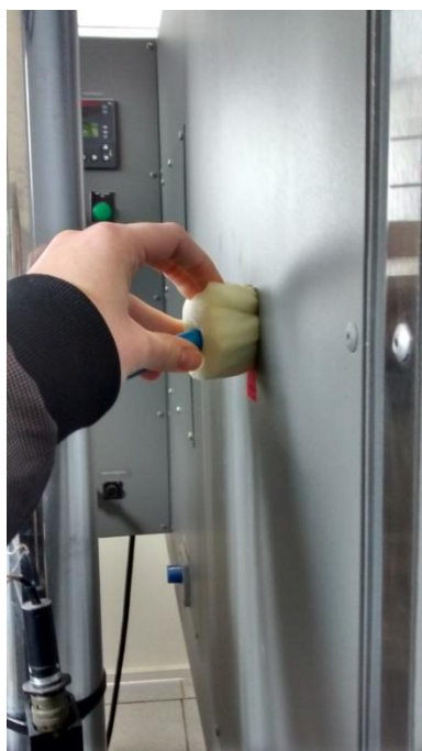
Figura B.10: isolamento lateral
