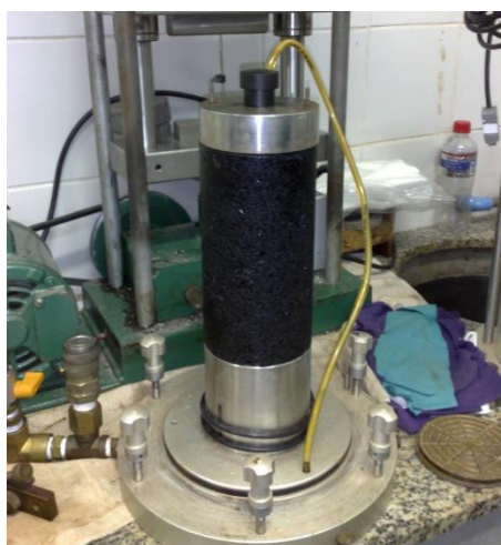
Figura B.11: montagem do CP na câmara triaxial
