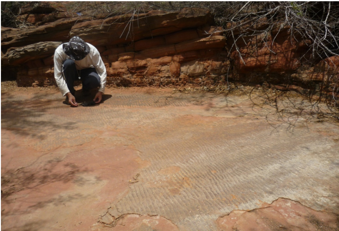
Figura 8. Imagem mostrando a coleta de dados de paleocorrente com a bússola de modelo tipo brunton em estruturas sedimentares em marcas onduladas.
