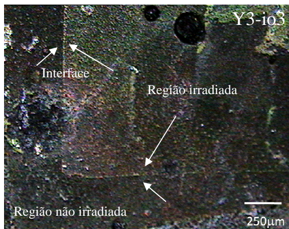
Figura 3.19 – Imagem de microscopia ótica para a amostra Y3-io3, destacando-se o contraste entre as regiões implantada e não implantada.
