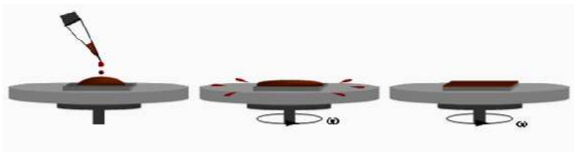
Figura 3.1 – Técnica de spin coating : após ser depositada a solução sobre o substrato, realiza-se a rotação do conjunto substrato+solução na velocidade de 6000 rpm durante dois minutos[82].
