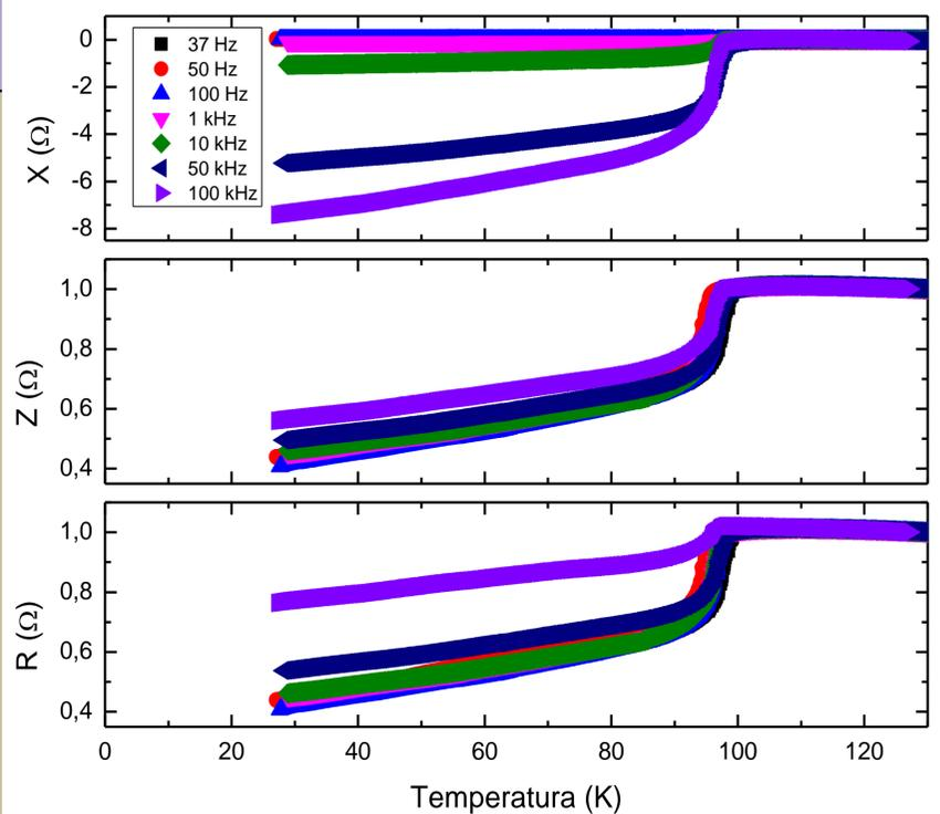
Figura 5: Comportamento da resistência  $R$ , da indutância  $X$  e da impedância  $Z$  em função da temperatura numa cerâmica de  $\text{YBa}_2\text{Cu}_3\text{O}_{7-\delta}$  para frequências de corrente de sonda de 37 Hz, 50 Hz, 100 Hz, 1 kHz, 10 kHz, 50 kHz e 100 kHz. As curvas de  $R$  e  $Z$  foram normalizadas em  $T = 130\text{K}$ .
