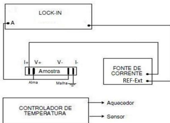
Figura 3: Diagrama em blocos do equipamento utilizado para as medidas.
