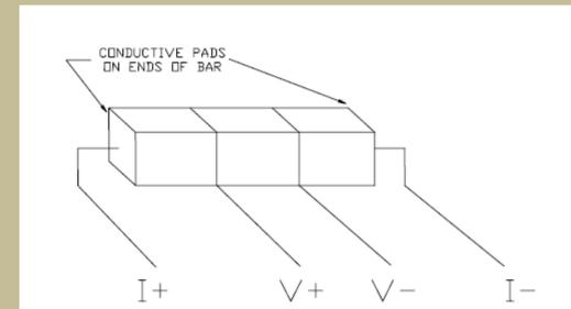
Figura 4: Esquema da amostra com os 4 contatos elétricos.
