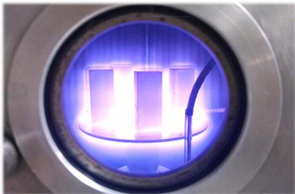
Figura 1 Nitretação a plasma de pinos para o ensaio DST (Figura2).
