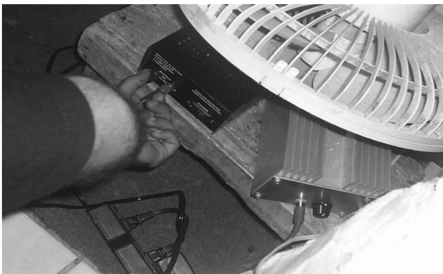
Figura 18: O tão polêmico e famigerado transmissor. O ventilador é colocado estrategicamente para dissipar o calor.
