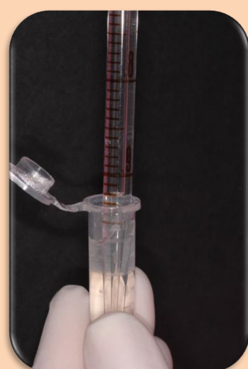
Fig. 6. Captação de 1ml da água de imersão
