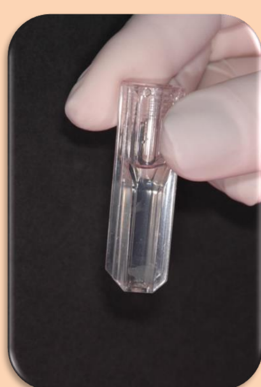
Fig 7. Precipitado de ferrocianato de potássio
