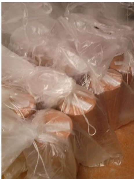
Figura 4. Acondicionamento de corpos-de-prova em sacos plásticos
