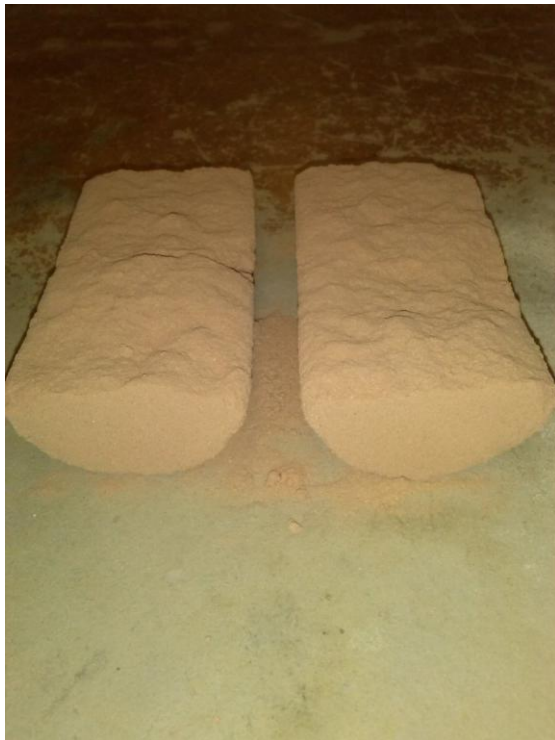
Figura 8. Corpo-de-prova rompido à tração
