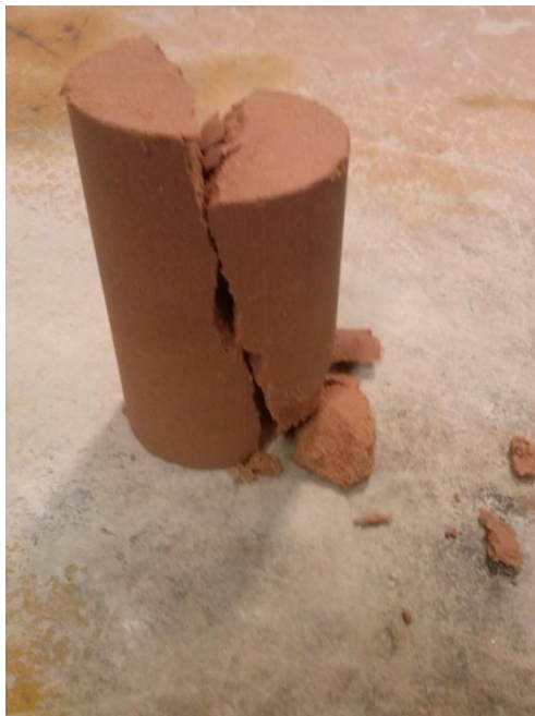
Figura 6. Ruptura à compressão
