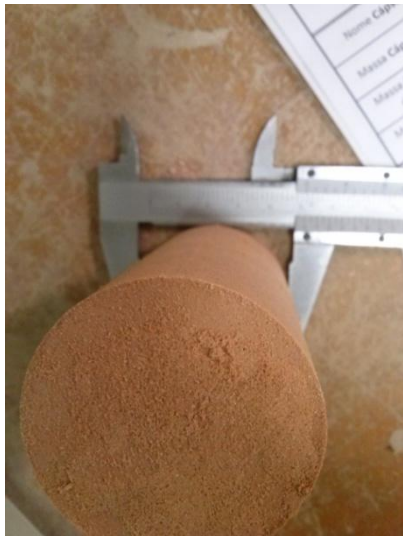
Figura 3. Medição de diâmetro da base com paquímetro
