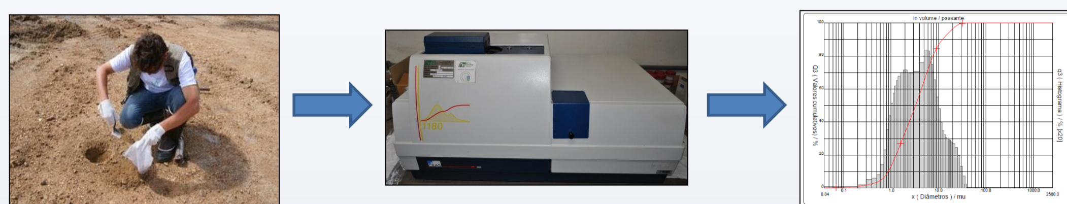
Figura 3. Esquema ilustrando a coleta de material, o equipamento utilizado (Analisador de Partículas a Laser) e os resultados obtidos a partir do mesmo.
