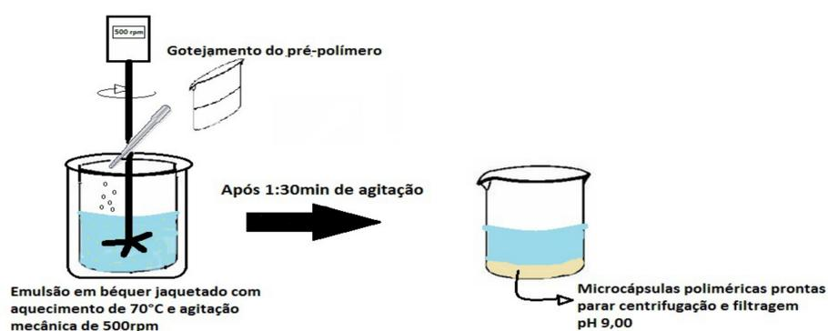
Para aplicação das mesmas, empregou-se o processo de impregnação em meio aquoso com 3 amostras de tecido algodão com medidas de 3 cm x 3 cm imersas em uma solução aquosa preparada com 5 g de resina acrílica, 100 ml de água deionizada e 1 g de microcápsulas em um béquer, com agitação mecânica de 120 rpm. Foram retiradas amostras com os tempos de 1 h, 2 h e 3 h.
