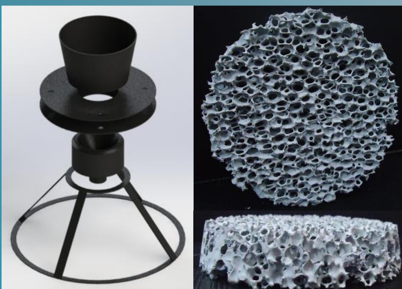
Fig.1 – Montagem do queimador. Matriz porosa de carbeto de silício com 10º de abertura.
