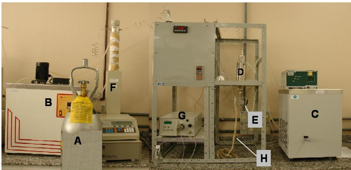
Figura 13: Fotografia do sistema utilizado para as extrações com fluidos supercríticos. (A) – cilindro de gás; (B) e (C) – banhos termostáticos; (D) – extrator; (E) - válvula agulha; (F) – bomba de alta pressão; (G) – bomba para solvente modificador; (H) - fita de aquecimento.
