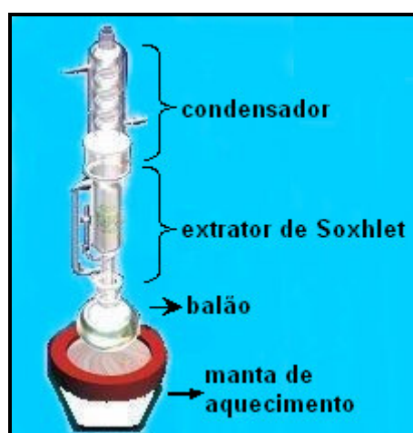
Figura 9: Esquema do extrator de Soxhlet utilizado na extração do óleo de semente de uva.
