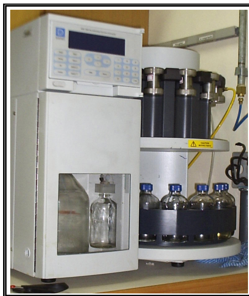
Figura 11: Equipamento de Extração acelerada por solventes da Dionex (ASE 300™)
