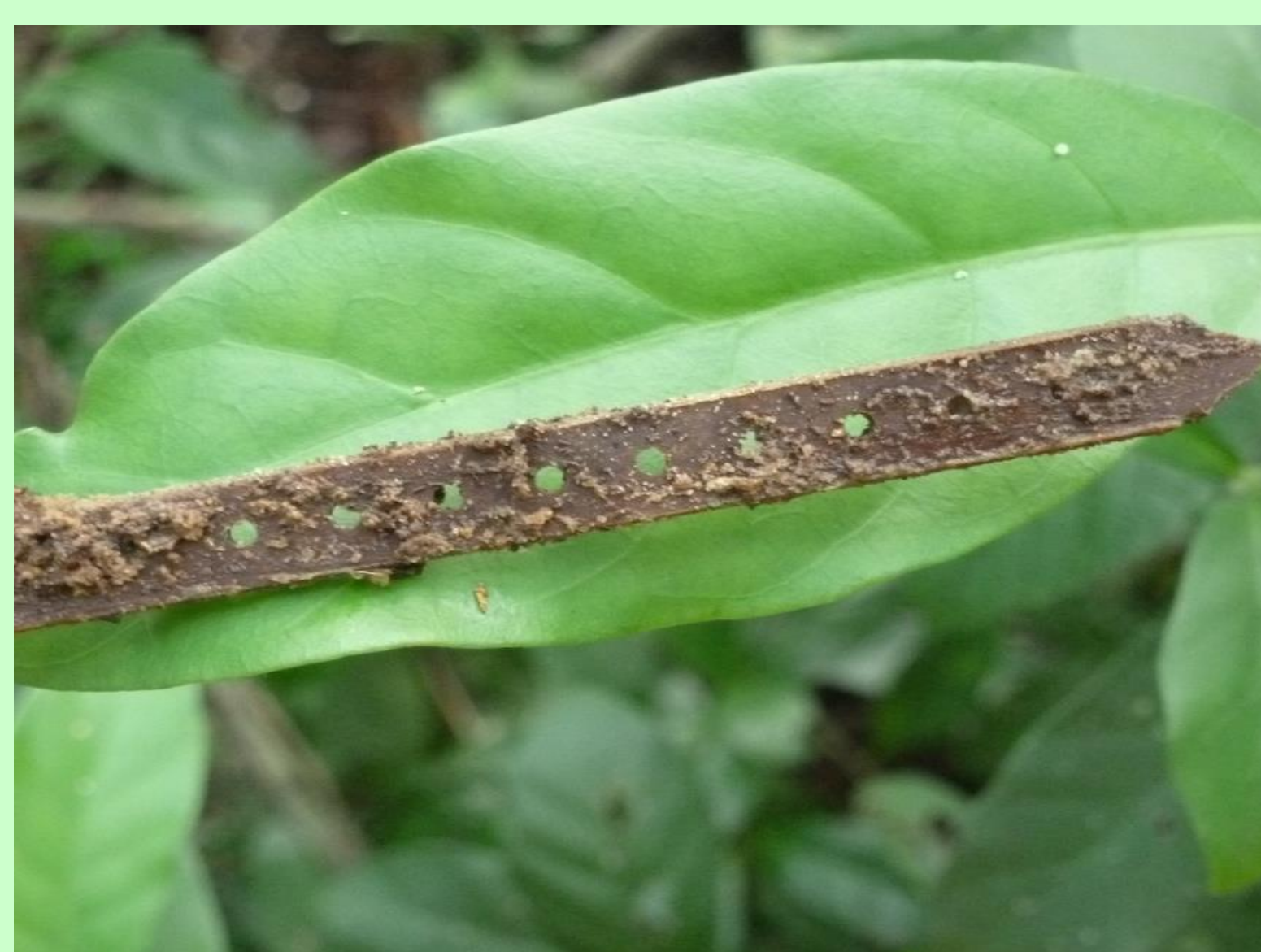
Figura 1: bait-lamina retirada em campo demonstrando indícios de consumo.
