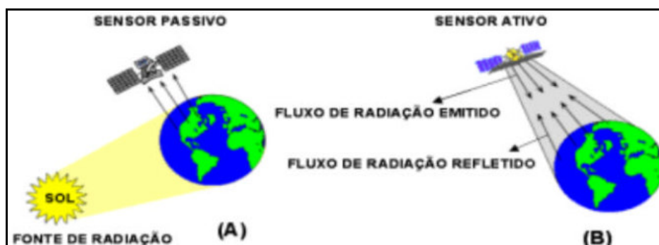
Fig.14: Sensores passivo (A) e ativo (B)
