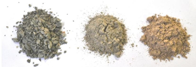
RCD nas diferentes etapas da produção: a - resíduo britado; b - após o peneiramento; c - após a calcinação
