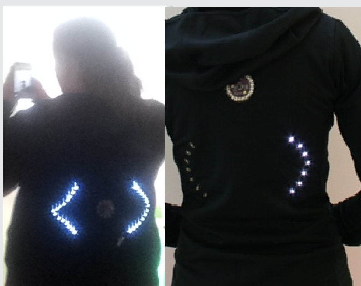
Figura 4 - Reprodução (E) do projeto turn signal jacket de Leah Buechley (D)
