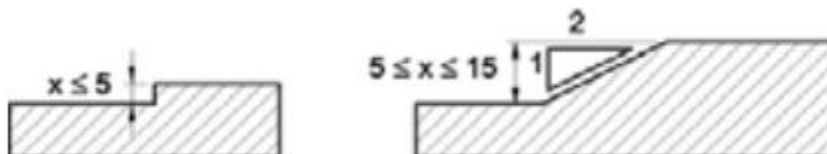
Figura 20 - Exemplo de Tratamento de Desníveis em Milímetros
