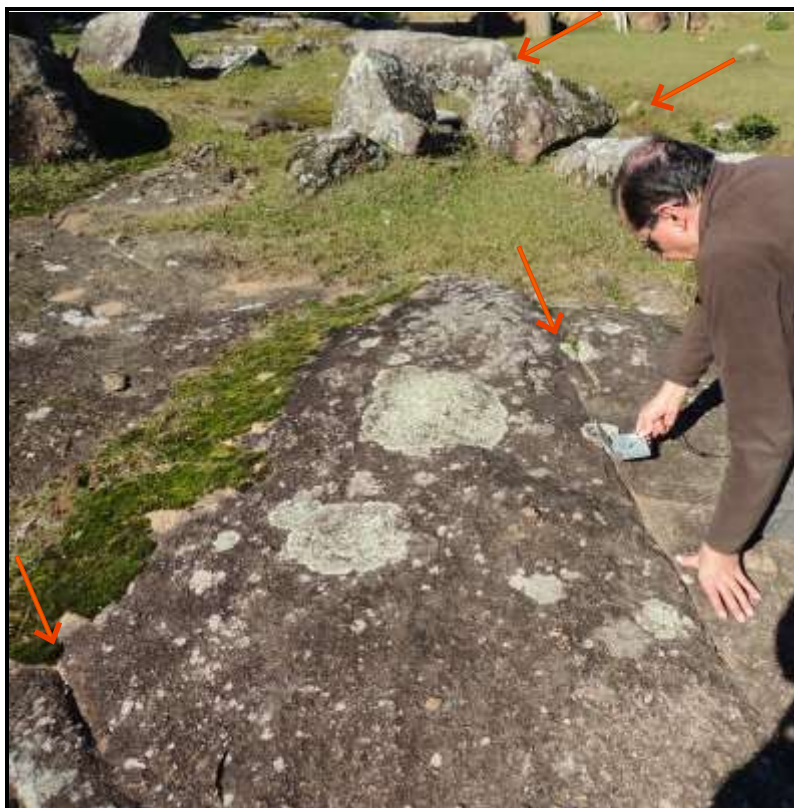
Figura 1: Determinação de orientação de falhas (direções apontadas pelas fechas) em afloramento de rochas graníticas (Suíte Dom Feliciano) na localidade de São Brás Alto. Principais: N76°E Secundárias: N40°W. Foto: acervo da autora, 2014.
