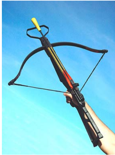
Figura 15. Detalhe da balestra e ponteira utilizadas na coleta de biópsias do tecido adiposo e pele de cetáceos (foto: Glauco Caon © ).
