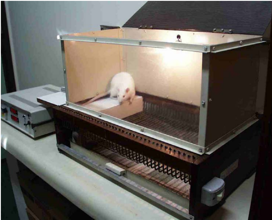
FIGURA 11. CAIXA DE CONDICIONAMENTO AUTOMATIZADA UTILIZADA NO TESTE DA ESQUIVA INIBITÓRIA.
