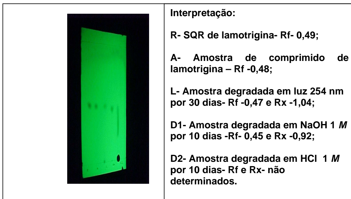
Figura 4.4. Cromatograma e Rf obtidos por CCD na análise da solução da SQR de lamotrigina (R), solução amostra dos comprimidos de lamotrigina (A), solução amostra degradada sob luz UV 254 nm (30 dias) (L), solução amostra degradada em hidróxido de sódio 1 M (10 dias)(D1) e solução amostra degradada em ácido clorídrico 1 M (10 dias) (D2) revelados por luz UV 254 nm.
