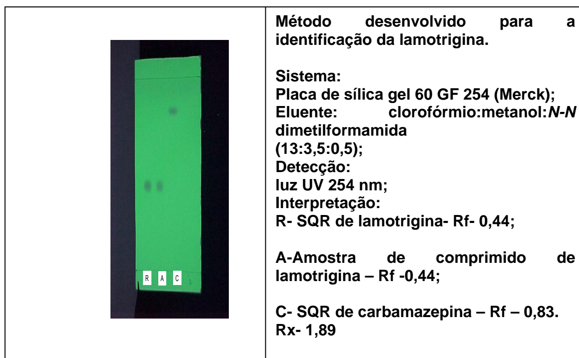
Figura 4.3. Cromatograma e Rf obtidos por CCD na análise da solução da SQR de lamotrigina (R), solução amostra dos comprimidos de lamotrigina (A) e da solução de carbamazepina SQR (C), revelados por luz UV 254 nm.
