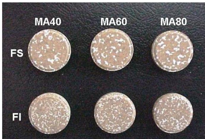
Figura 5.19: Aspectos da face superior (FS) e face inferior (FI) de comprimidos MA40, MA60 e MA80 produzidos em máquina alternativa
