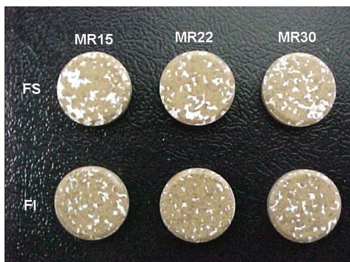
Figura 5.27: Face superior (FS) e face inferior (FI) de comprimidos produzidos em máquina de comprimir rotativa nas velocidades de 15 (MR15), 22,5 (MR22) e 30 (MR30) rpm
