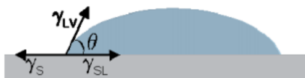
Figura 2: Ângulo de contato ( \Theta ) entre uma gota e uma superfície.
