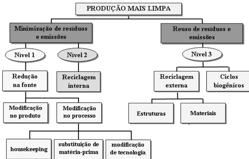
Figura 10 – Níveis para a identificação de opções de não geração e minimização de resíduos, efluentes e emissões na implementação da metodologia de PmaisL (Fonte: SENAI, 2002)
