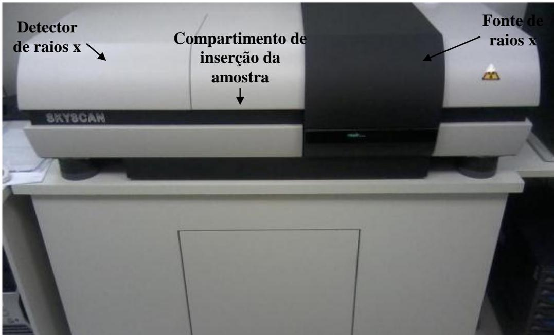
Figura 23: Microtomógrafo de raios-x utilizado
