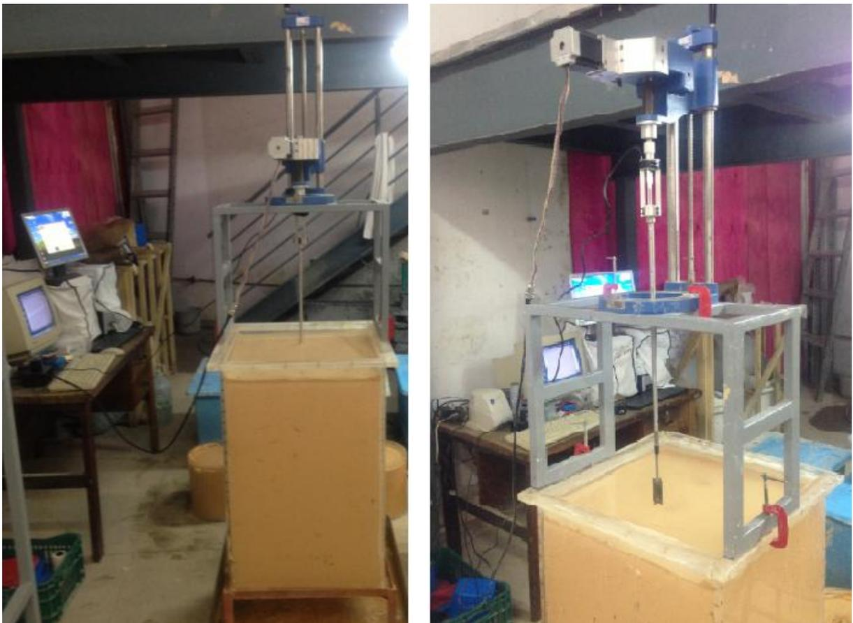
Figura 5.11: Execução do ensaio de mini palheta em profundidade.
