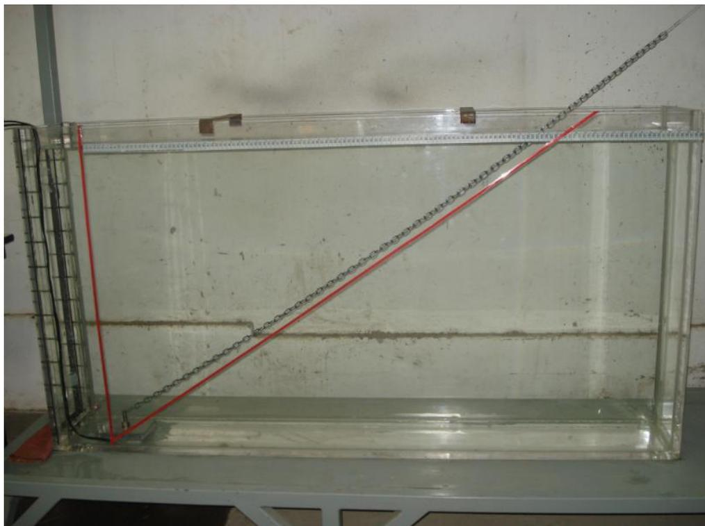
Figura 5.26: Calibração da célula de carga em água.
