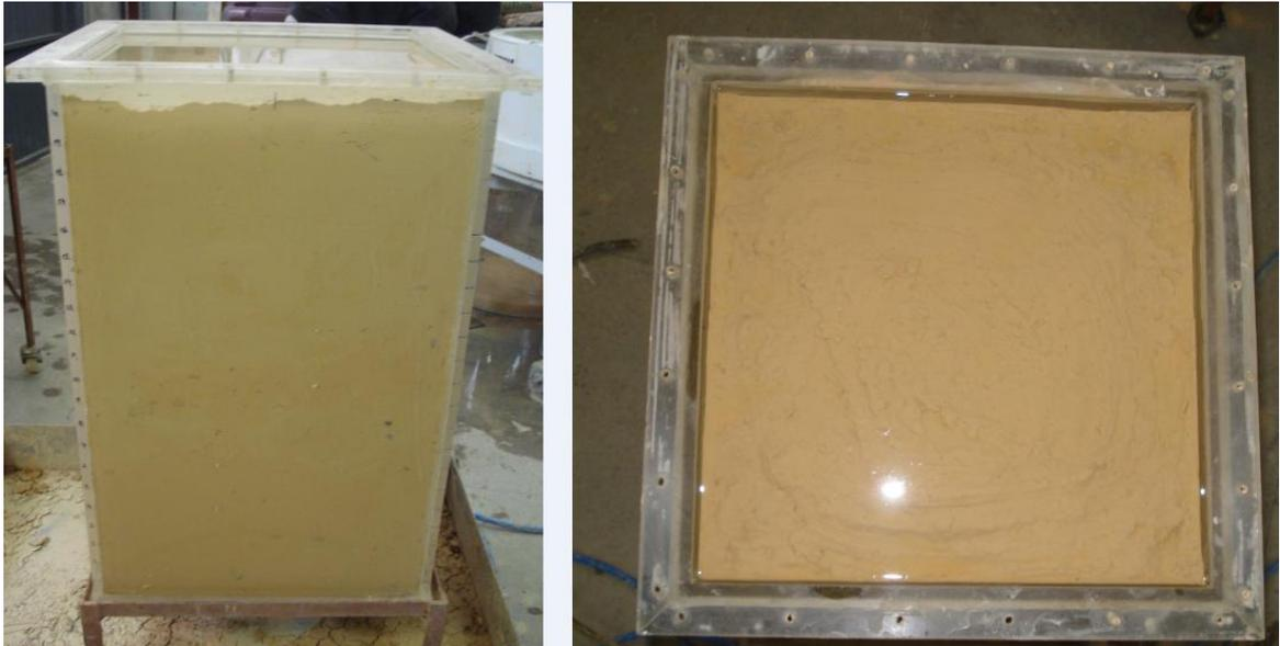
Figura 5.9: Tanque de acrílico utilizado nos ensaios de palheta.
