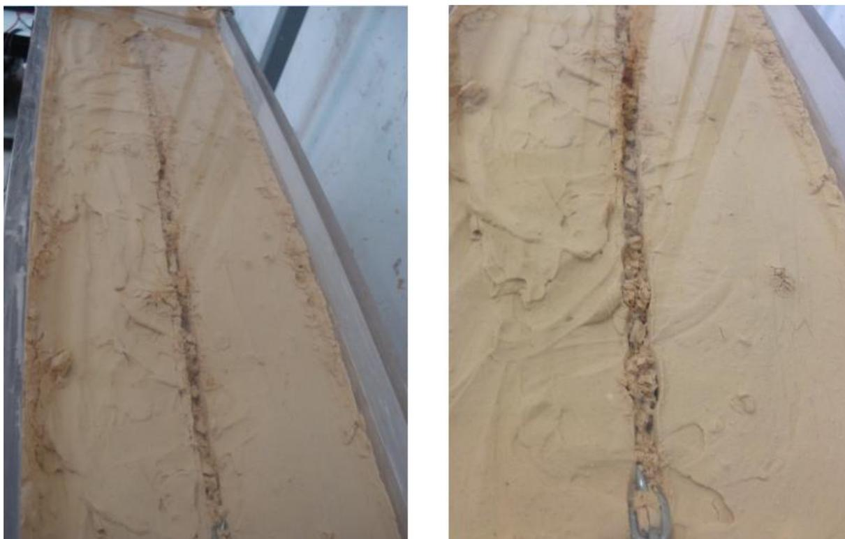
Figura 5.34: Ruptura do solo devido à aplicação de carga com componente horizontal na amarra.
