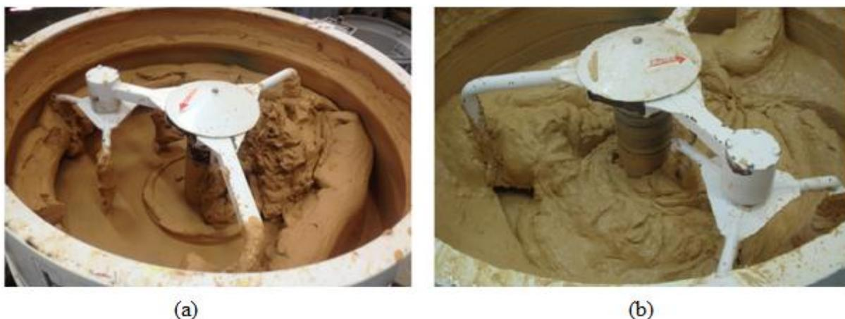
Figura 5.28: Moldagem: (a) mistura A (100% de umidade) e (b) mistura B (120% de umidade), respectivamente.
