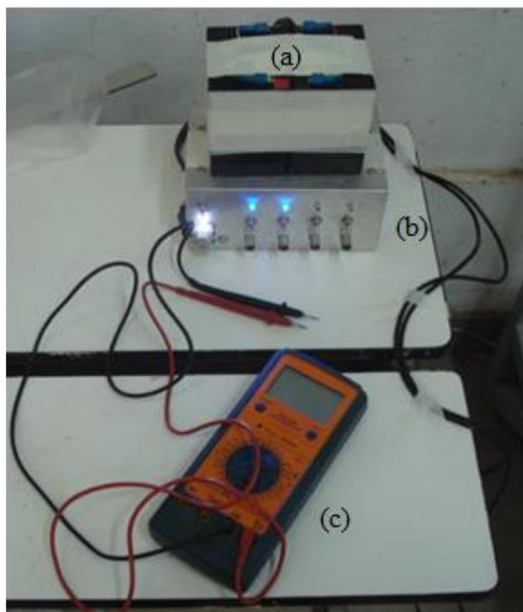
Figura 5.25: Equipamentos de aquisição dos dados: (a) Bateria, (b) Amplificador e (c) Multímetro.
