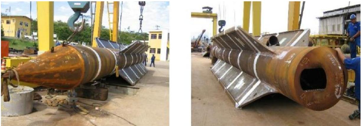
Figura 2.7: Detalhe da geometria da estaca torpedo (SAGRILO et al., 2010)
