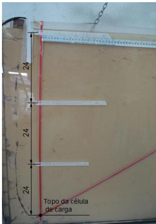
Figura 5.29: Marcação da posição da corrente ao longo da profundidade.
