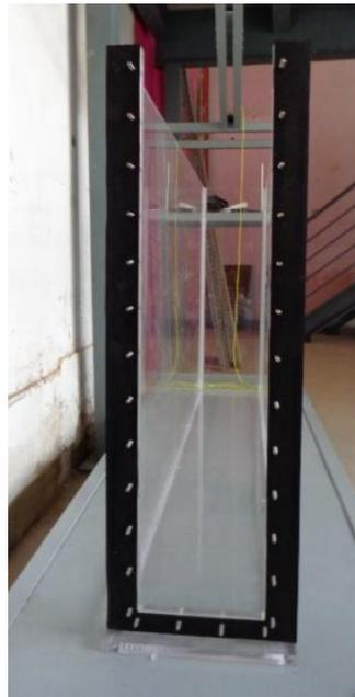
Figura 5.14: Lateral móvel do tanque em acrílico.
